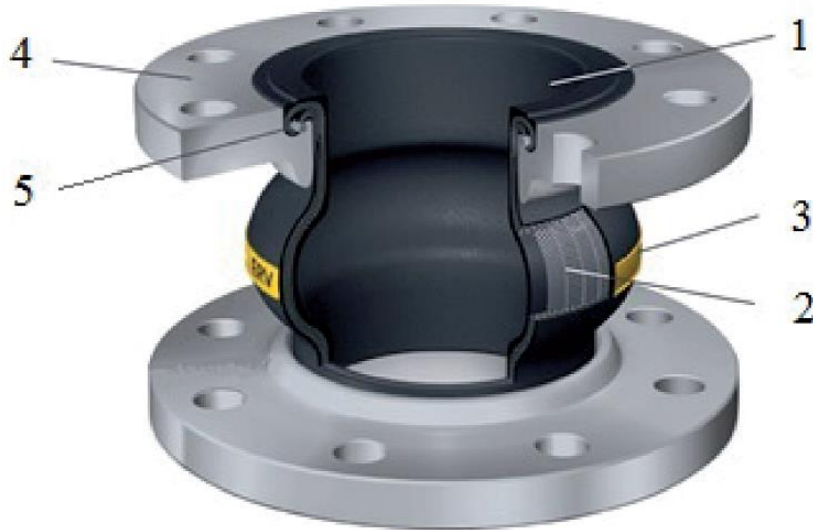
Rys. 1. Przykładowa konstrukcja kompensatora gumowo-metalowego [2]; 1 – warstwa wewnętrzna, 2 – warstwa wzmacniająca, 3 – warstwa zewnętrzna, 4 – kołnierz metalowy, 5 – pierścień wzmacniający
