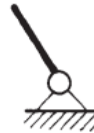
Rys. 2. Rodzina 5 – jeden stopień swobody [Miller 1989]
