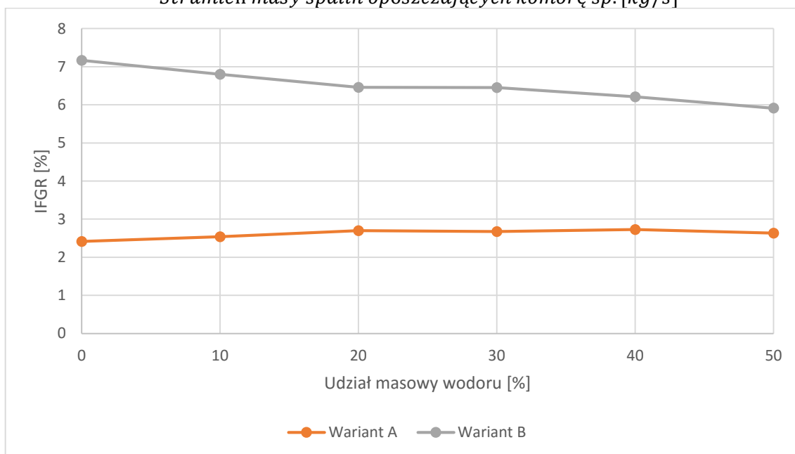
Rys. 4.7 Stopień zawracania spalin IFGR w komorach spalania
