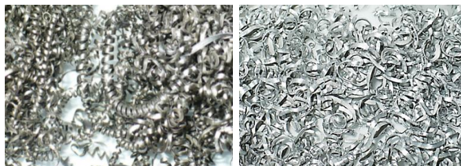
Rys.15. Zastosowany dodatek do parafin: wióry stalowe (po lewej), wióry aluminiowe (po prawej) [A7]
