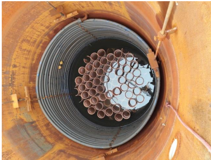
Rys. 15. Złoże szkieletowe: a) wykonane z pionowych rur - widok, b) zalane wodą dla prób ciśnienia - widok. [fotografia G. Wałowski]
