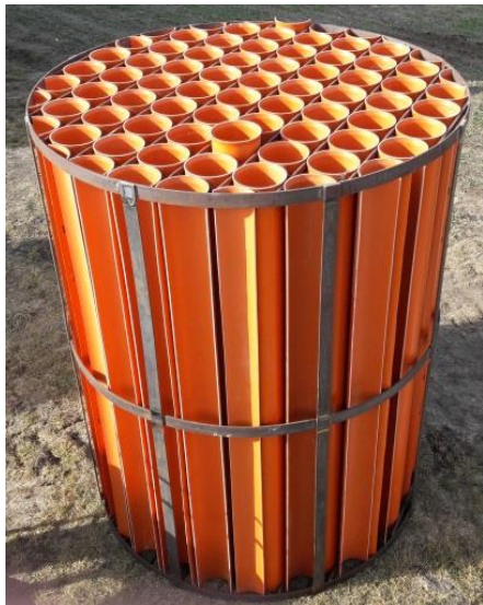
Rys. 15. Złoże szkieletowe: a) wykonane z pionowych rur - widok, b) zalane wodą dla prób ciśnienia - widok. [fotografia G. Wałowski]
