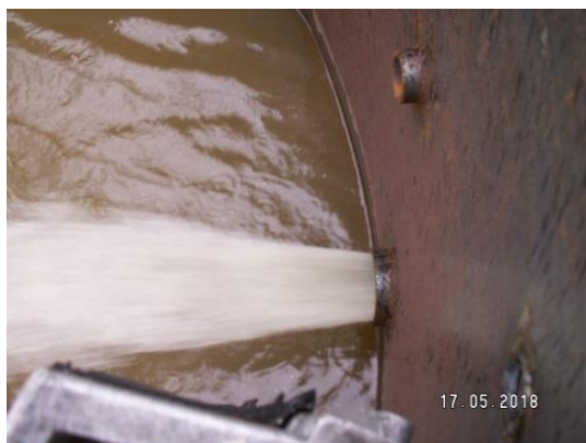
Rys. 16. Układ mieszania w reaktorze - tłoczenie czynnika inertnego podczas próby szczelności [fotografia G. Wałowski].
