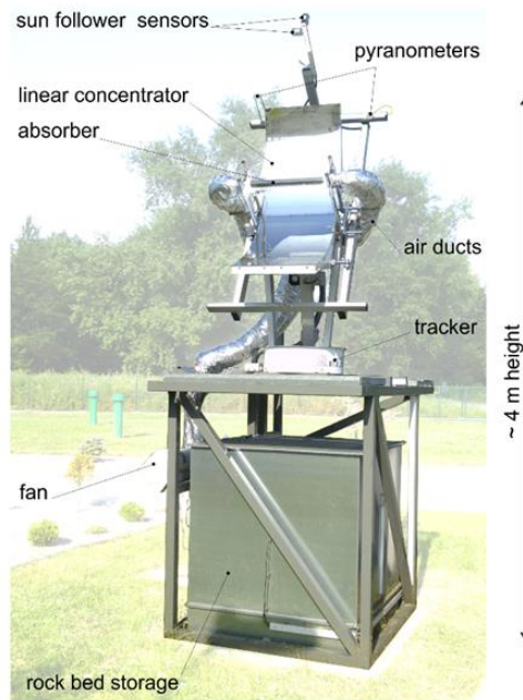
Rys. 24. Stanowisko do badania akumulacji ciepła z instalacji słonecznej [A4]
