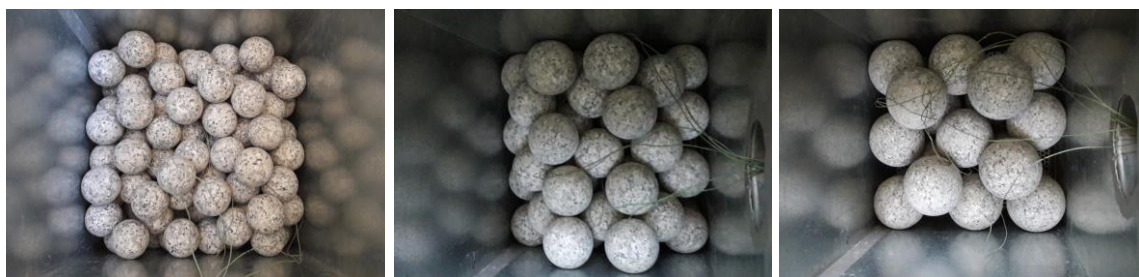
Rys. 5. Ułożenie w złożu kul o średnicy (od lewej): 50 mm, 70 mm, 90 mm [A3]
