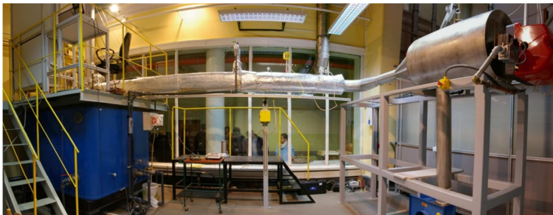
Rys. 2. Stanowisko do badania odzysku ciepła ze spalin zainstalowane w Zakładzie Mechaniki i Systemów Energetycznych Politechniki Wrocławskiej
